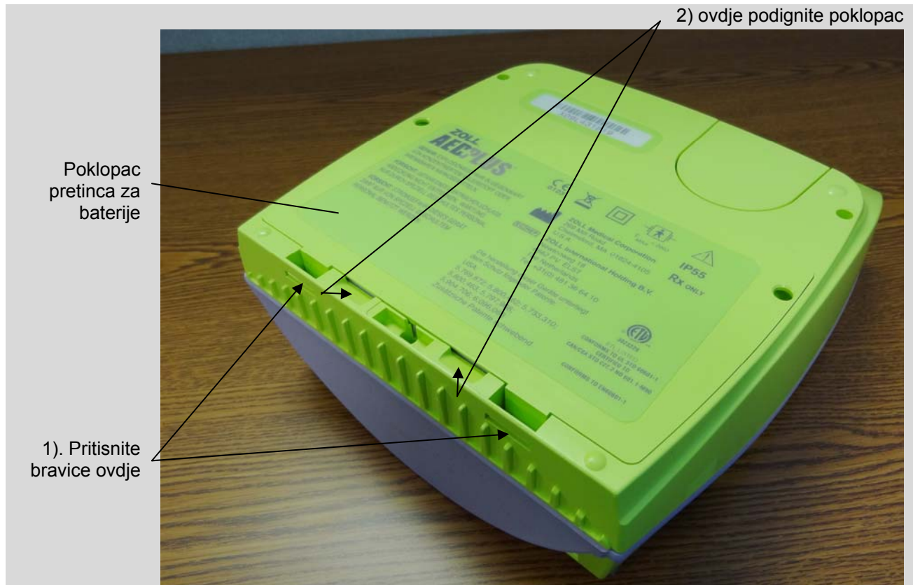
Slika 7: Podizanje poklopca pretinca za baterije
